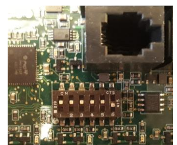
Рис 6 Положение DIP-переключателя для использования обогревателя
