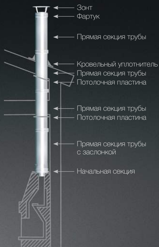
Монтаж сверху камина
