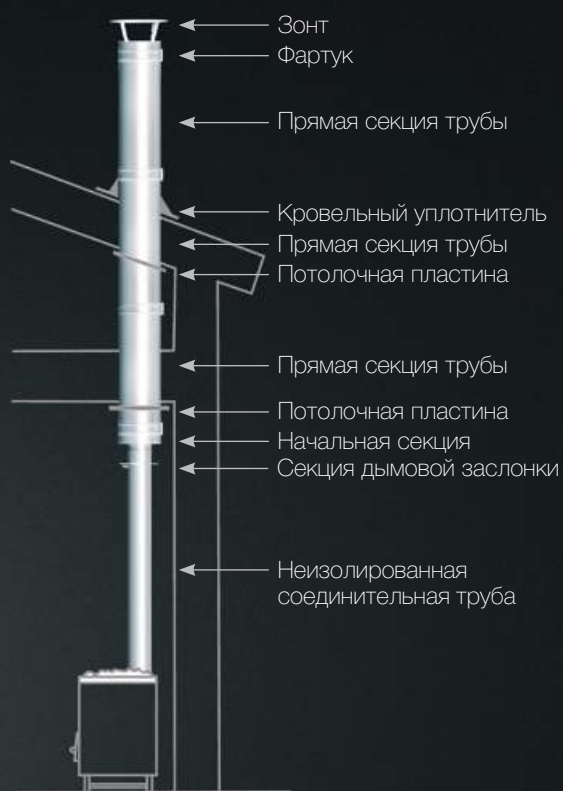
Монтаж с неизолированной соединительной трубой
